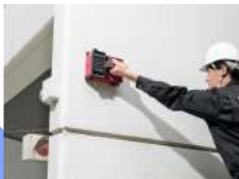
トンネルの浮き・はく離箇所がわかる
